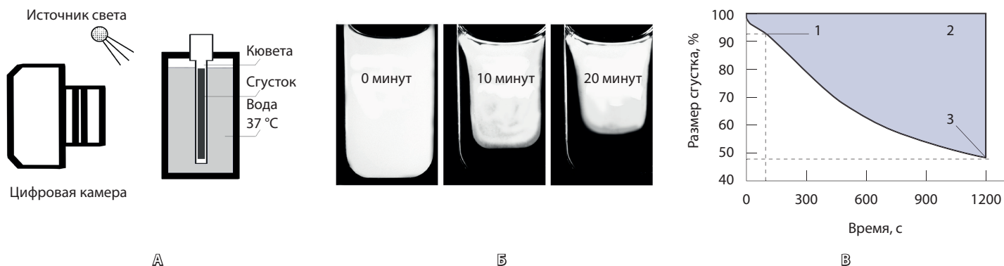
Рис. 2. Аппаратный метод изучения кинетики контракции сгустков крови. Свертывание цельной цитратной крови и активация тромбоцитов инициируются одновременно добавлением тромбина и ионов кальция, после чего плоская кювета с кровью помещается в термостатируемый оптический регистратор (А). Серия фотографий сгустка (Б) анализируется с помощью программы, которая строит кинетическую кривую (В) и рассчитывает параметры контракции: 1 – лаг-период (время, необходимое для уменьшения размера сгустка менее 95% от исходного); 2 – размер сгустка в конечной точке относительно исходного (степень контракции), 3 – площадь над кинетической кривой (отражающая механическую работу тромбоцитов по сжатию сгустка)
