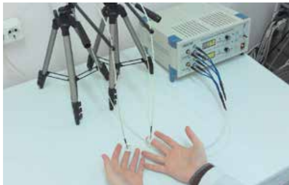
Рис. 1. Пример проведения измерений с помощью двухканального оптоволоконного лазерного доплеровского анализатора «ЛАКК-02»
