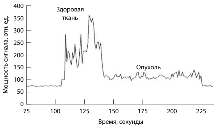
Рис. 7. Зависимость мощности автодинного сигнала от времени при выпаривании излучением CO 2 -лазера здоровой и опухолевой тканей молочной железы
