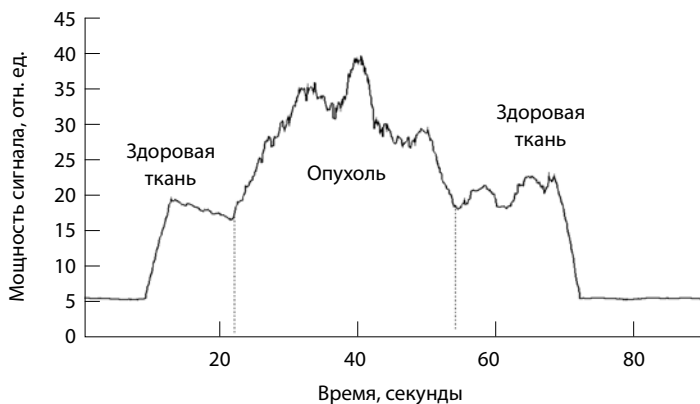
Рис. 6. Зависимость мощности автодинного сигнала от времени при удалении рака гортани человека
