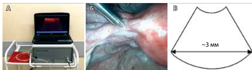
Рис. 1. Общий вид ОКТ-установки (А); процедура ОКТ-лапароскопии (Б); схема ОКТ-изображения с характерным масштабом кадра (В)
