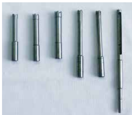
Рис. 2. Цилиндрические полые фрезы разного рабочего диаметра
